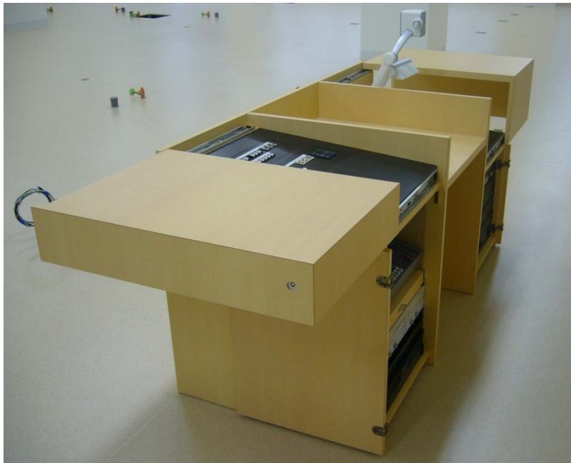
機器収納型AV操作卓
